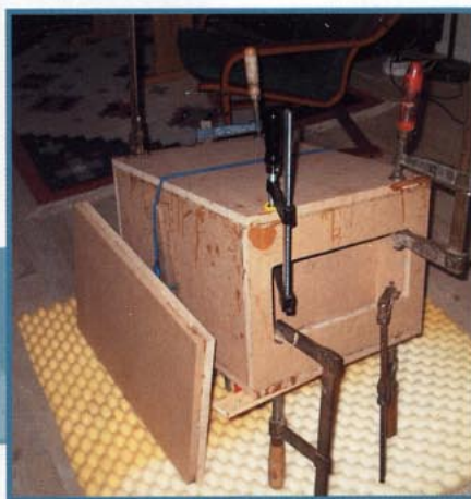
Ekspanderende lim er noe griseri, men du verden så effektivt. Tvinger anbefales!
