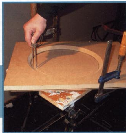
Etter å ha frest ut hullet rundt elementet i ytterplaten, er det en small sak å måle til og sage ut hullet i innerplaten.
