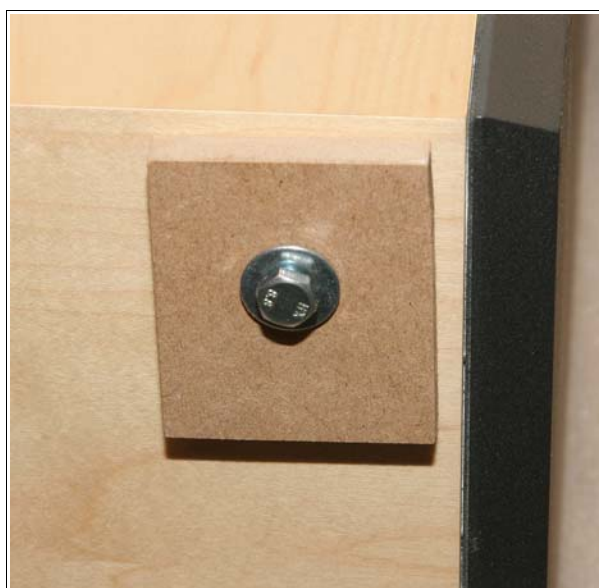
Bilde 4: Trekk på plass islagsmutterne.
